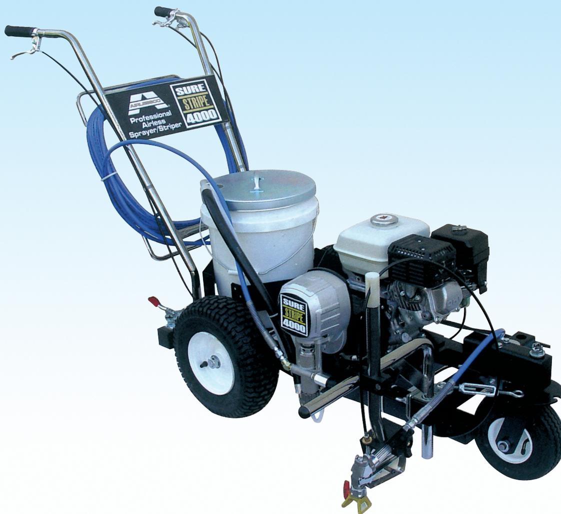
Traccialinee con pompa airless a pistone e motore a scoppio montata su carrello
