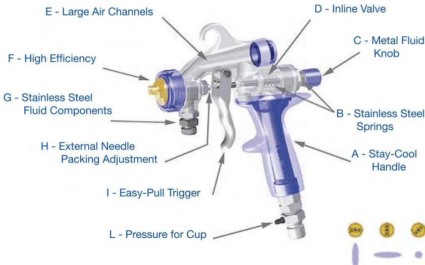
L'aerografo XT è progettato per lasciar passare l'aria solo quando il grilletto viene azionato, ciò significa minor circolazione di polvere e minor accumulo di vernice sull'ugello. I componenti a contatto con la vernice sono in acciaio inox e il manico dell'aerografo XT è in nylon per isolare la mano dal calore dell'aria.
